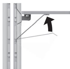
③ テール部分がシングルトレー取付金具の2つ下の切り欠きにはまったら、ヘッド部分を起こします。
