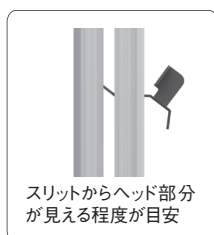
②スリット内部の金属レールに干渉しない位置まで押し込みます。
