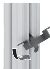
③90度回転させてから、ヘッド部分を引き抜きます。
