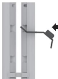
②スリット内部の金属レールに干渉しない位置まで押し込みます。
