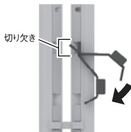
①TUGUCAタテのスリットに、オプション取付金具(小)のヘッドをスリットを中心まで差し込み、90度回転させます。
