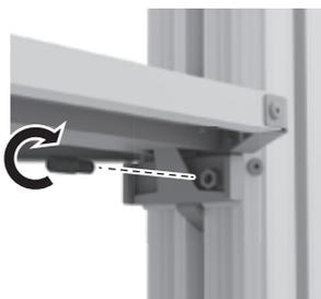
オプション固定ネジを右回りに回し、最後までねじ込みます。シェルフトップの取り付け完了です。
