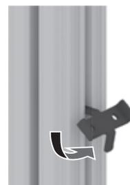
③90度回転させてから、ヘッド部分を引き抜きます。
