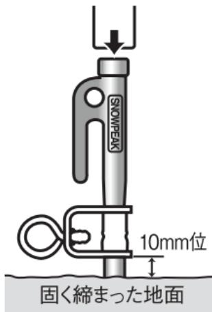
固く締まった地面にハンマーなどを用いて本体を回転パーツの下10mm位まで垂直に打ち込みます。
