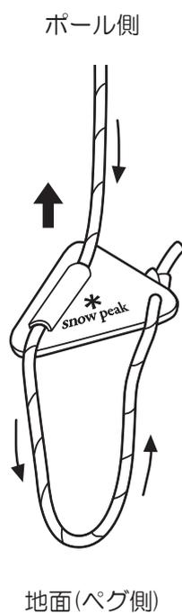
ロープにテンションを掛けるには、矢印の方向にロープを移動しながら自在を上方向にスライドさせます。
