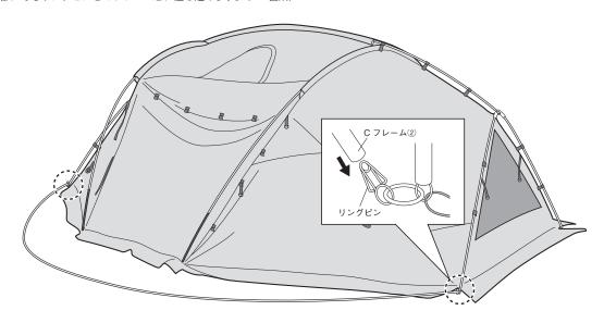
**9** Cフレーム②を持ち上げて、Cフレーム②とCフレーム①のライン上のプラスチックフックを全て取り付けます。(15箇所)
