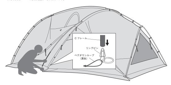
**8** C フレーム②を伸ばし、連結部をしっかりと連結し、A フレーム端部にあるリングピンを C フレーム②に差し込みます。(×2 箇所)
