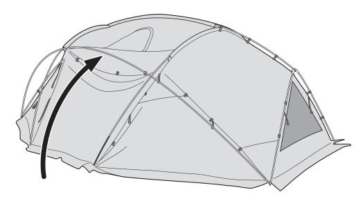
① C フレーム①と C フレーム②の交点を本体についているベルクロで留めてください。このとき、2 本のフレームを束ねるようにベルクロを通してください。(2 箇所) 次にベンチレーションのバーを起こしてベルクロで固定します。(2 箇所)
