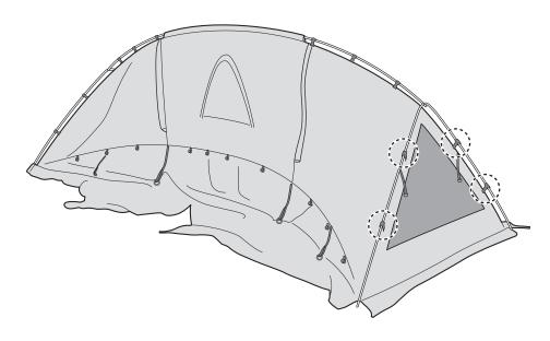
**6** 両端の節が黒色のCフレーム①を少しずつ継ぎ、黒色のテープが付いたスリーブに通してください。 このとき、1人で無理にフレームを通すとスリーブ、またはフレームが破損する場合があります。 フレームをスリーブに通す際は、押し込む人の反対側でもう1人がスリーブの端部を持ち上げて作業を行ってください。
