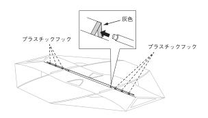
Aフレームジョイント部にリッジフレーム先端を差し込んでください。この時、Aフレームのロゴが外側を向いている事を確認してください。 次にセンターリングをAフレーム先端に取り付けて、アジャスターベルトベルトを引きテンションを加えます。反対側も同様です。
