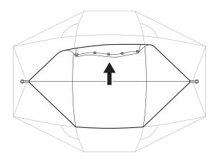
③ リッジフレーム用ベルクロをリッジフレームに巻き付けて固定します。 次にセンターリングをリッジフレーム先端に掛けてアジャスターベルトを引きます。反対側も同様です。
