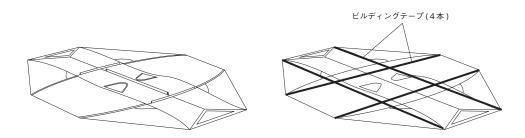
(2) センタースリーブにリッジフレームを通し、スリーブの延長線上にあるプラスチックフック(×6)をリッジフレームに取り付けます。
