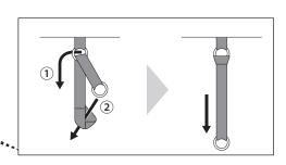
② リング付きベルトをCフレーム②に巻き付けてリングに自在付きロープ5mを取り付けてペグで固定します。
