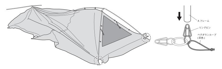
**(5)** Aフレームのライン上にあるプラスチックフックをAフレームに取り付けてください。(左右4箇所ずつ) この時、③のセンターリングのアジャスターベルトが緩んでいないか確認してください。 ベルトが緩んでいる場合、ベルトを調整してテンションを加えてください。
