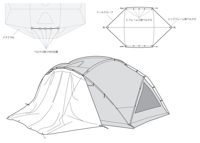
(2) 下図のようにシールドルーフをメラクPro.本体の天井に覆いかぶせ、反対側のCフレーム②用ベルクロをCフレーム②に巻き付けます。
