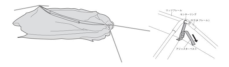
4 本体(三角窓)裾部にある灰色のペグダウンループが付いたリングピンをAフレーム端部に差し込んでください。 Aフレーム先端に取り付けて、アジャスターベルトベルトを引きテンションを加えます。反対側も同様です。
