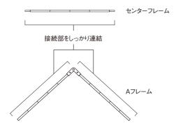
③ ●の箇所("各部の名称"を参照)を確認し、センタースリーブにセンターフレームを通します。
