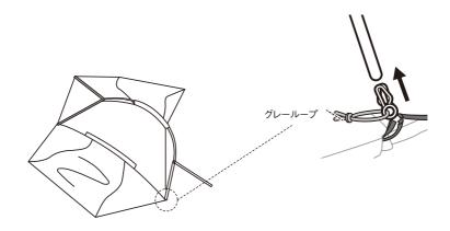
フレーム全体をゆっくり起こしながら、リングピンを手前に引き寄せてください。Aフレームのもう片方の先端を本体側のリングピンに差し込みます。
