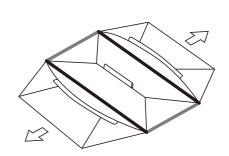
② センターフレームとAフレーム×2を伸ばし、接続部をしっかりと連結します。 ※フレームの連結部分に隙間ができないようにしっかり差し込んでください。
