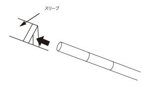
スリーブに通し終えたら、Cフレームの先端を外側のリングピンに差し込みます。 Cフレームの反対側の先端も同様に差し込みます。
