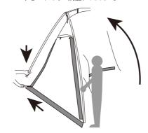
(Cフレーム×2を伸ばし、接続部をしっかりと連結します。 ※フレームの連結部分に隙間ができないようにしっかり差し込んでください。
