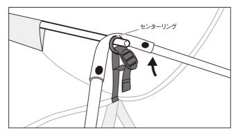
6 Aフレームの先端を本体側のリングピンに差し込みます。×2箇所
