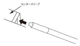
4 Aフレームをリッジポールに接続します。Aフレームに付いている黒色シールが外側に向くようにリッジポールを差し込みます。リッジポールの先端が最後までAフレームに差し込まれている事を確認してください。
